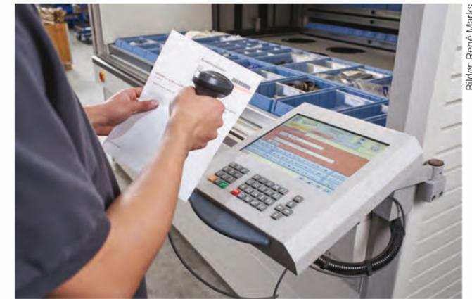
▲ Vom ERP-System generierte Aufträge werden gescannt und an der Hänel-Steuerung MP 14 N angezeigt.
