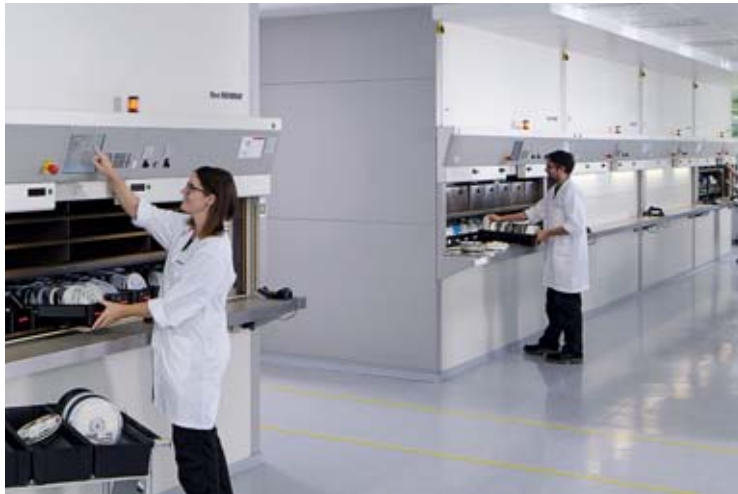
Selbst Aufträge mit hunderten Positionen werden durch paralleles Kommissionieren innerhalb kürzester Zeit für die Produktion zusammengestellt.
