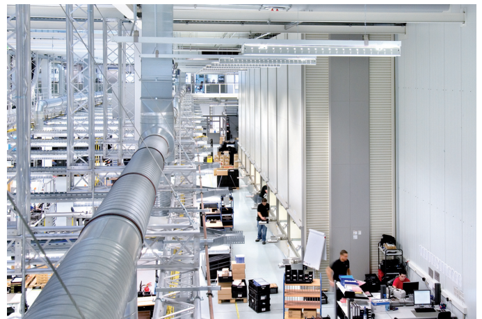
Durch die Höhenoptimierung verdichten derzeit zwölf kompakte Leanlifte von Hänel auf der geringen Stellfläche von nur etwa 100 m 2 einen Lagerplatz von nahezu 1200 m 2 .
