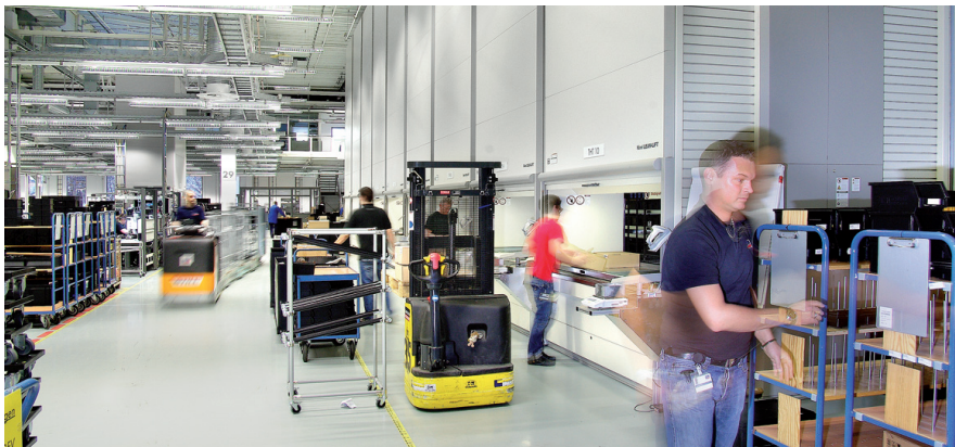
Gleichzeitige «Ware-zum-Mann» Kommissionierungen mit kurzen Zugriffszeiten durch parallele Bedienung mehrerer Personen an unterschiedlichen Lean-Liften und Rotomaten.
